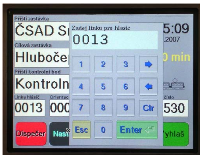
Příklad zadávání čísla linky u počítače pro tramvaje
