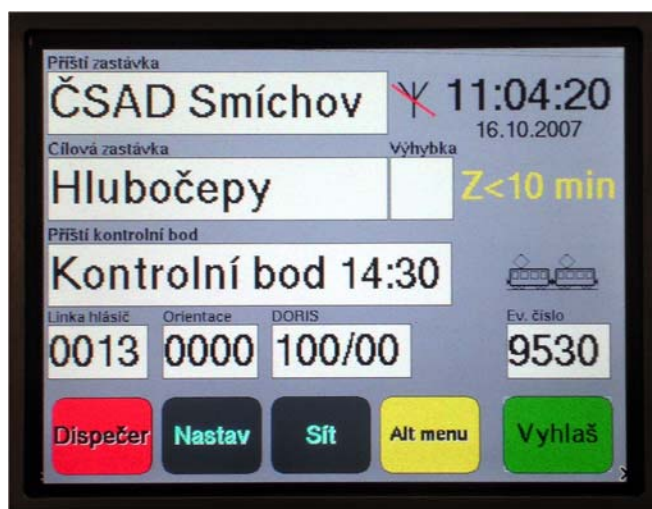
Příklad zadávání čísla linky u počítače pro tramvaje
