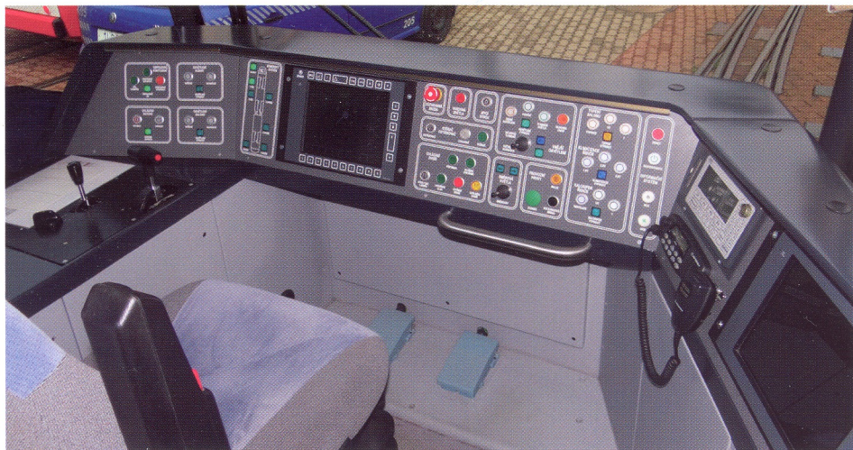
Stanoviště řidiče tramvaje EVO2 pro Liberec je osazeno moderními ovládacími prvky, které jsou ergonomicky uspořádané. (foto: Petr Dvorský)
