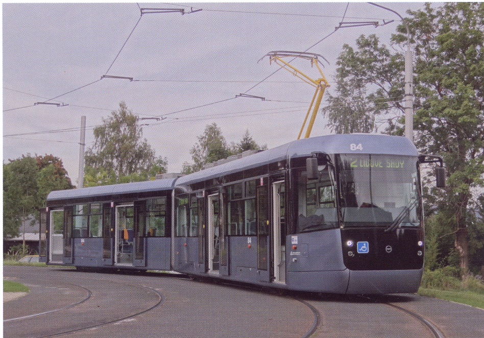
Tramvaj EVO2 zachycená první den provozu (25. 9. 2012) na smyčce Dolní Hanychov. Všechny dveře tramvaje jsou koncipovány jako vně předsvuné. (foto: Petr Dvorský)
