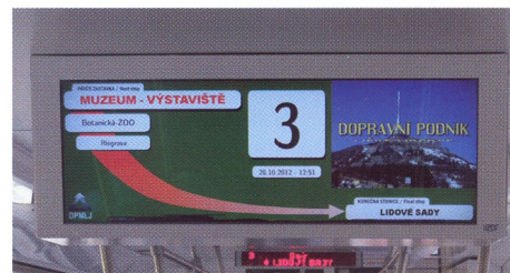
Dodatečně byl do tramvaje EVO2 instalován v říjnu 2012 oboustranný LCD panel APEX VIS-01.
