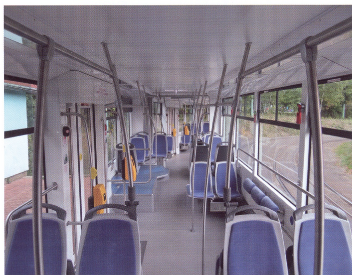
Dva pohledy do interiéru tramvaje EVO2. Ačkoli je tramvaj vykazována jako 100% nízkopodlažní, je zde 100% nízkopodlažnost vnímána stejně jako u autobusů a trolejbusů, tj. že nízkopodlažní jsou vstupy, průchozí ulička a pouze části ploch v interiéru. To je dobře patrné na levém snímku. Bezbariérový přístup vede k 19 z 45 sedaček. (foto: Petr Dvorský). Pravý záběr ukazuje detail uspořádání sedaček nad podvozkem, kde je ulička lomená jako říční meandr a sedadla jsou situována na podestách, přičemž u některých míst k sedění je ještě vyvýšená plošina. (foto: Libor Hinčica)
