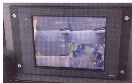
EVO2 je vybavena i kamerovým systémem od společnosti AMIT. Řidiči se zobrazuje dění ve voze na displeji, přičemž je možné sledovat buďto všechny čtyři kamery, anebo volit jenom jednu konkrétní.
