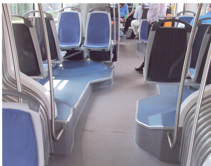
Dva pohledy do interiéru tramvaje EVO2. Ačkoli je tramvaj vykazována jako 100% nízkopodlažní, je zde 100% nízkopodlažnost vnímána stejně jako u autobusů a trolejbusů, tj. že nízkopodlažní jsou vstupy, průchozí ulička a pouze části ploch v interiéru. To je dobře patrné na levém snímku. Bezbariérový přístup vede k 19 z 45 sedaček. (foto: Petr Dvorský). Pravý záběr ukazuje detail uspořádání sedaček nad podvozkem, kde je ulička lomená jako říční meandr a sedadla jsou situována na podestách, přičemž u některých míst k sedění je ještě vyvýšená plošina. (foto: Libor Hinčica)
